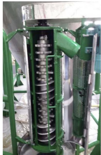
Para el caso del Ecomill 500, se cuenta con una sola entrada de agua, donde se puede ajustar el consumo de agua; para el Ecomill 1500 se tienen 2 entradas de agua las cuales se calibran a 3 litros por minuto cada una y para el Ecomill 3000 se tienen 3 llaves, La superior se calibra a 6 litros por minuto y las 2 restantes a 3 litros por minuto.
