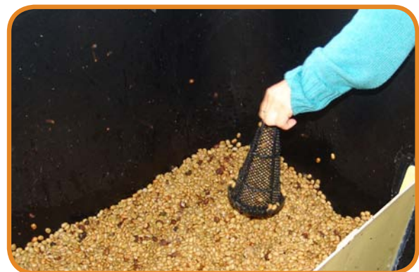
Figura 2. Cono truncado dentro de la masa de café en proceso de fermentación.
