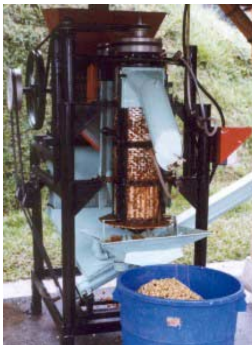
Figura 1. Módulo BECOLSUB 1000 , con capacidad para procesar 1000 kg de café cereza por hora, construido en Cenicafé.
