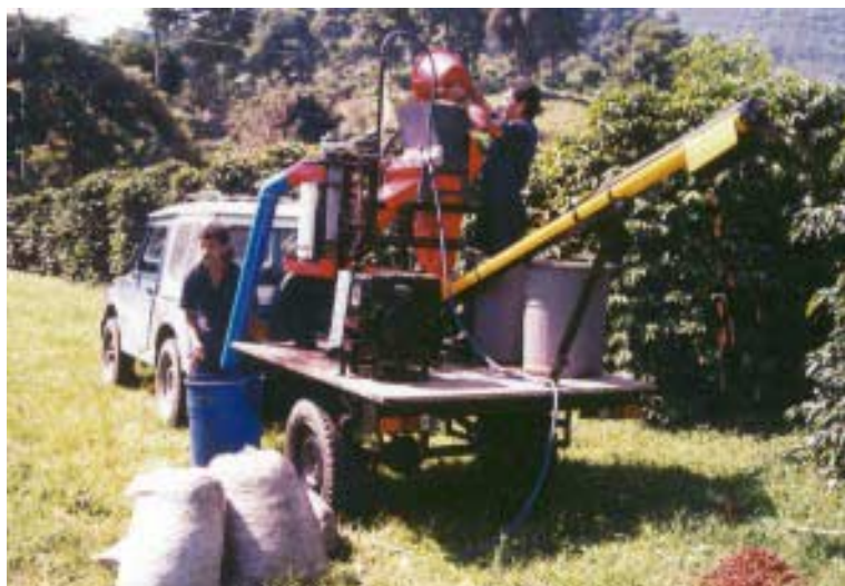
Figura 8. BECOLSUB 600 móvil, construido en Cenicafé, operado en el campo.
