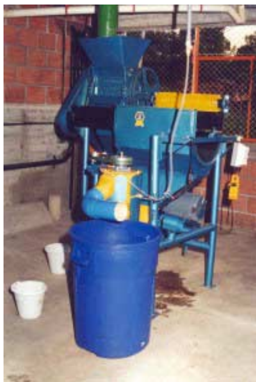
Figura 9. Módulo BECOLSUB 600 con zaranda construido por la industria privada con base en el diseño de Cenicafé.
