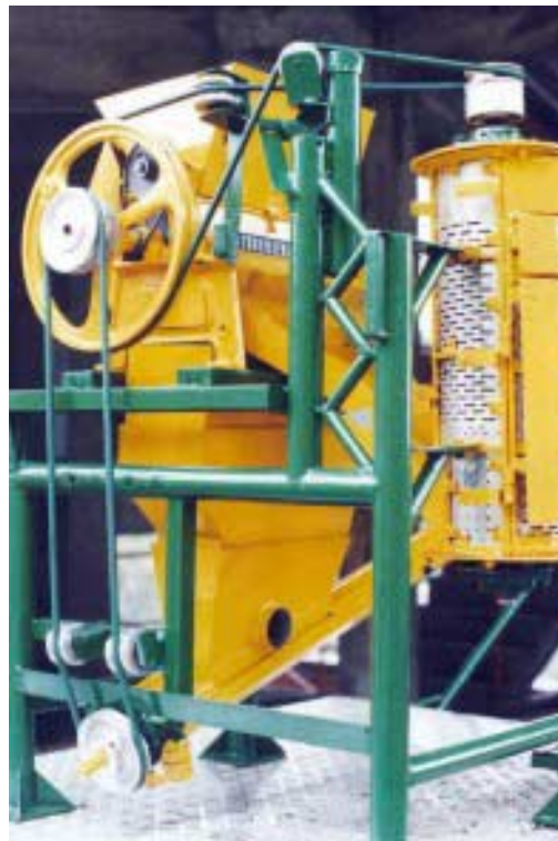
Figura 10. Transmisión de potencia en un módulo BECOLSUB.
